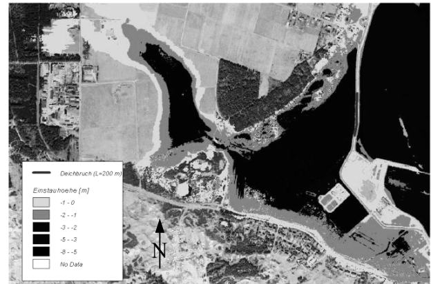
Abb. 11. Überflutung bei einem Bruch des Überlaufdeiches bei Wittdün und einem Wasserstand von + 4,15 m NN.
