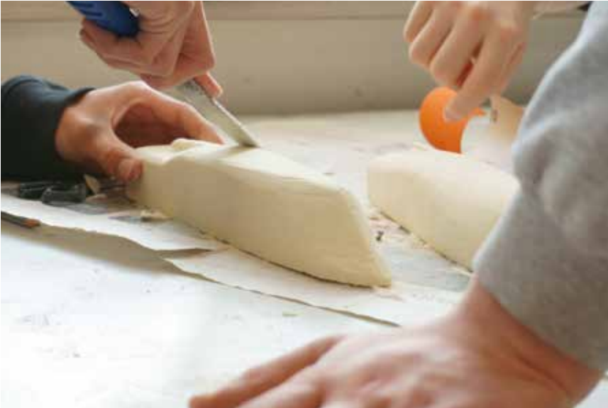
Mit Raspel und Schmirgelpapier wird aus einem Hartschaumblock ein Modellschiff
