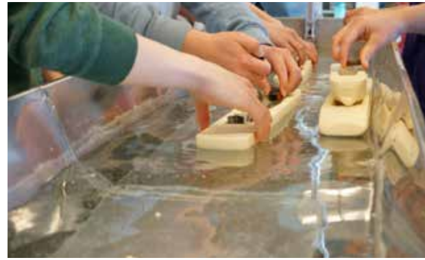
Gewichte simulieren den Tiefgang echter Schiffe
