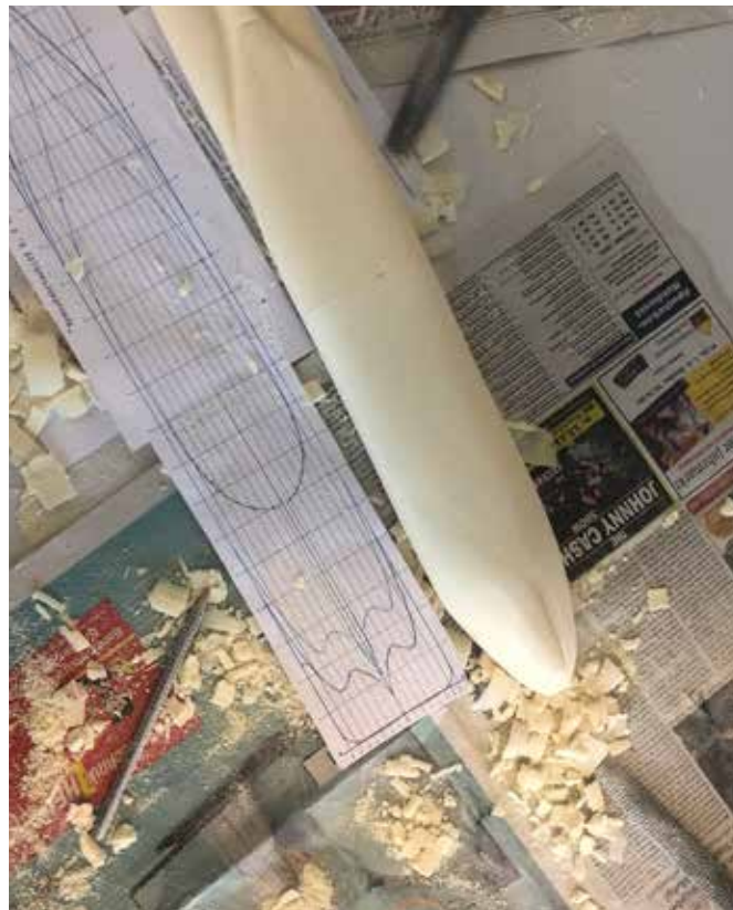
Linienrisse zeigen die Form eines Schiffes, wie eine Landkarte die Höhenlinien eines Berges
