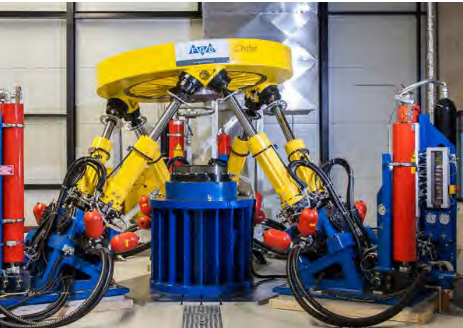
Der drei Meter hohe Hexapod ruht auf einem räumlich abgekoppelten Betonsockel
